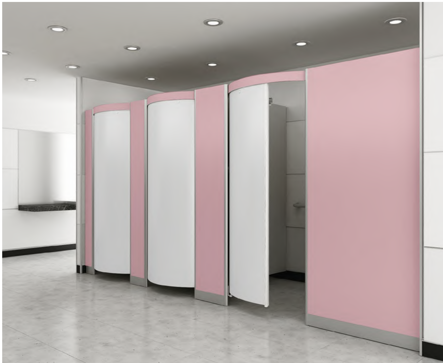
다목적 라운지 다목적(장애인) 라운지 2000 × 2070 × t30mm 앞면 더존패널, 측면 방수 PB, LED표시창/절전등 가능
